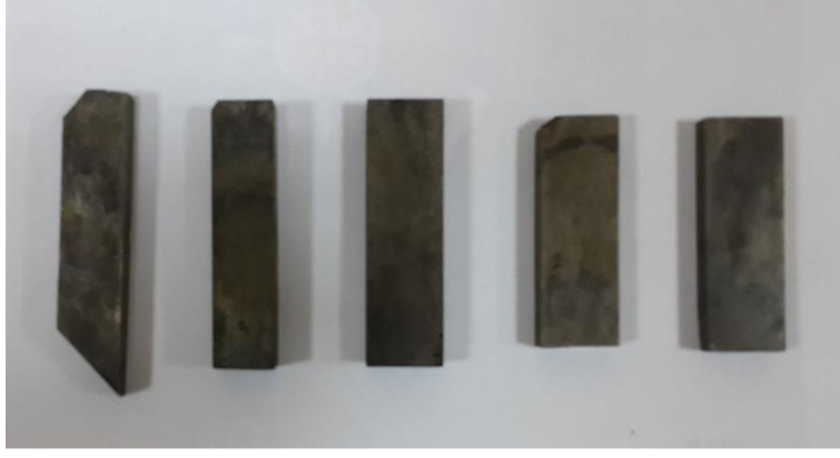
Şekil 16: 1000 °C'de 60 dakika süre ile borlanan numunelerin yüzey görünümü
