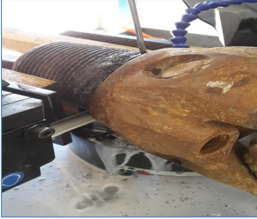
Şekil 14: Sondaj Matkaplarının kaplama işlemleri için kesimi
