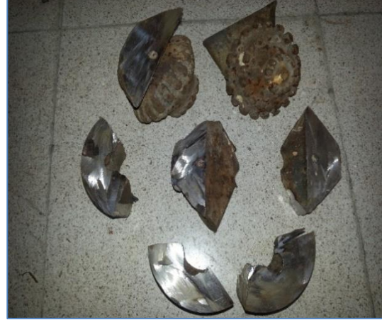
Şekil 14: Sondaj Matkaplarının kaplama işlemleri için kesimi
