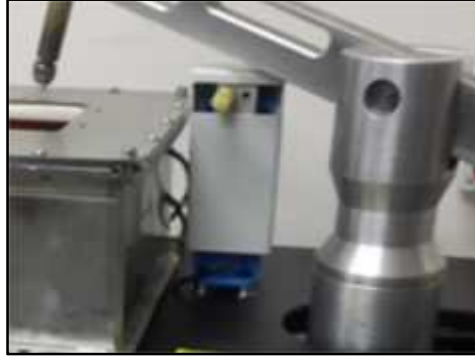
ekil 71: Pin-on-disk cihazı üzerinde sürtünme kuvveti değerlerini ölçen yük sensörü (load cell).
