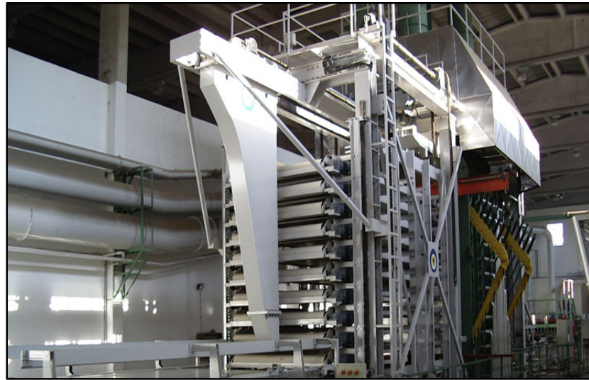
Şekil 14: Katlı pres (Multi opening press) genel görünüşü (URL-16, 2013).
