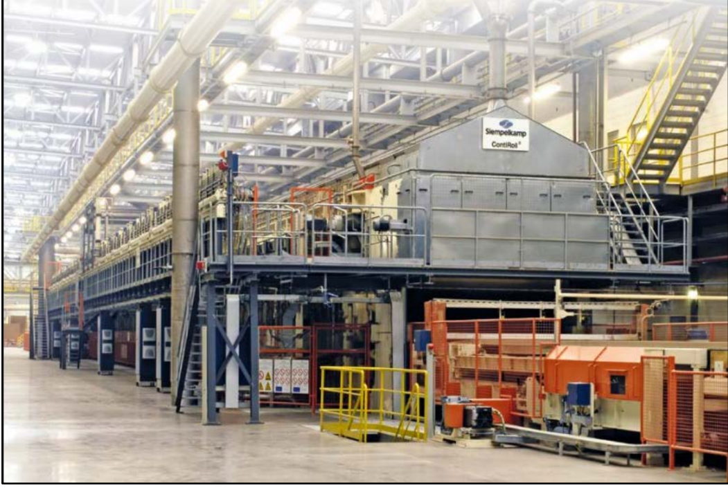
Şekil 21:Continu pres (Fotoğraf: Ufuk AYDIN 2016).
