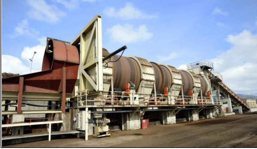
Şekil 11: Döner tamburlu kabuk soyucu (Fotoğraf: Ufuk AYDIN 2016).
