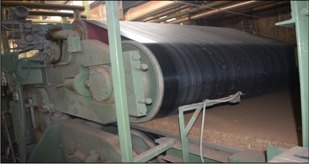
Şekil 19: Ön pres (Fotoğraf: Ufuk AYDIN 2016).
