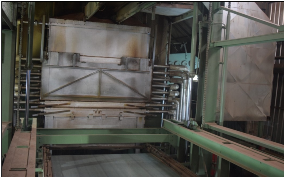
Şekil 20: Çok katlı pres (Fotoğraf: Ufuk AYDIN 2016).
