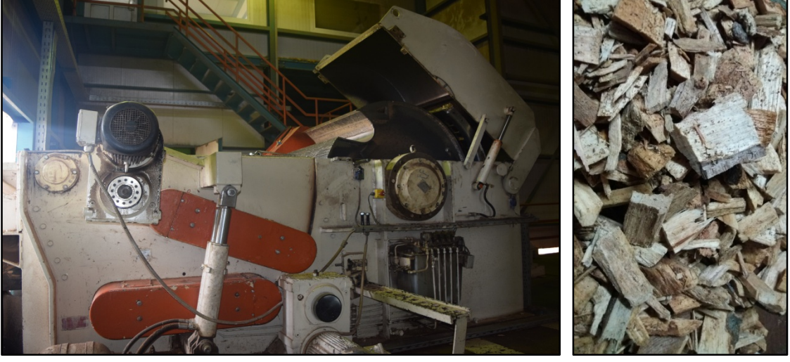
Şekil 12: Çipperi (Yongalayıcı) ve yonga (Fotoğraf: Ufuk AYDIN 2016).
