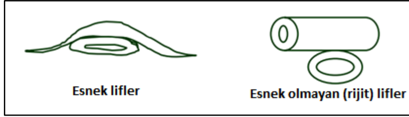
Şekil 2: Hornifikasyon ile liflerin esnekliğini yitirmesi (URL-2, 2016).
