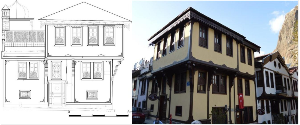
Şekil 4.30: 497. Ada'da yer alan III. geleneksel konutun giriş cephe planı ve genel görünümü (Kunduracı ve Bahargülü, 2018).
