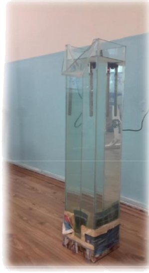
Şekil 9. Kol hacmi ölçüm aracı.
