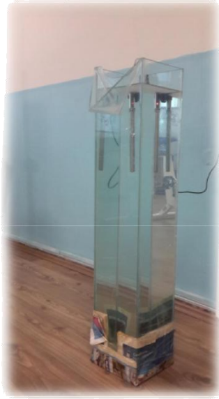
Şekil 10: özel tasarlanmış kol hacmi ölçüm aracı
