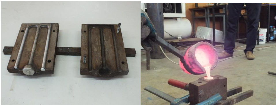
Şekil 6: Döküme hazır olan bir kum kalıbın kesiti ve döküm görüntüsü.
