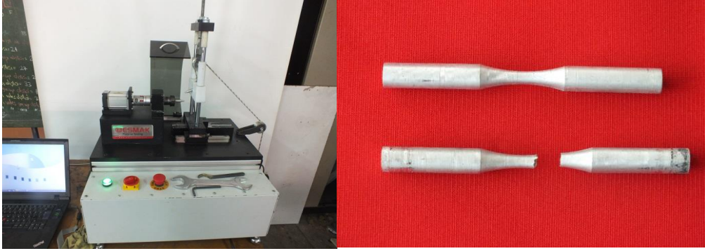
Őekil 19: Dnel eęilmeli yorulma cihazı ve yorulma numunesi.
