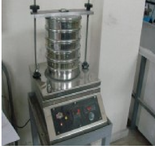
Şekil 12: Sarsma makinası ile kiremit tozu elek analizi.
