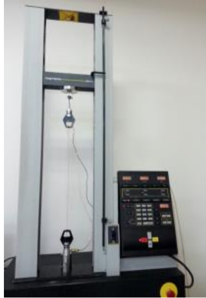
Şekil 26: INSTRON 4411 test cihazında kopma mukavemeti ve uzama oranı testi
