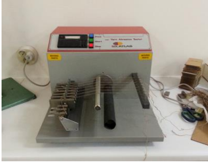
Şekil 27: SDL ATLAS test cihazında iplik sürtünme dayanımı testinin yapılması.
