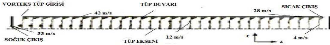
Şekil 1: CFX çözümünden oluşturulan hız profilleri (Fröhlingsdorf ve Unger, 1999).
