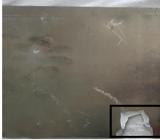
Şekil 6.9: kaplamasız plakanın balistik deney sonrasındaki görüntüsü.
