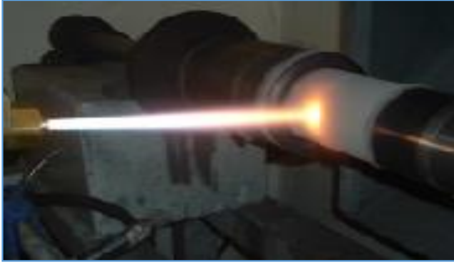
Şekil 2.4: HVOF kaplama yönteminin uygulanışı (Yonar, 2009).
