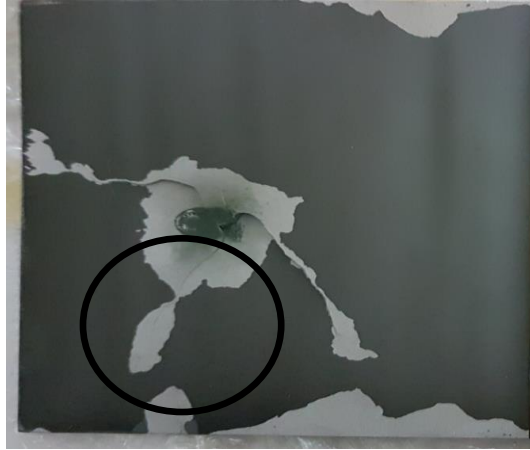
Şekil 6.13: Alüminyum oksit+Krom oksit kaplı plakanın balistik deney sonrasındaki görüntüsü.
