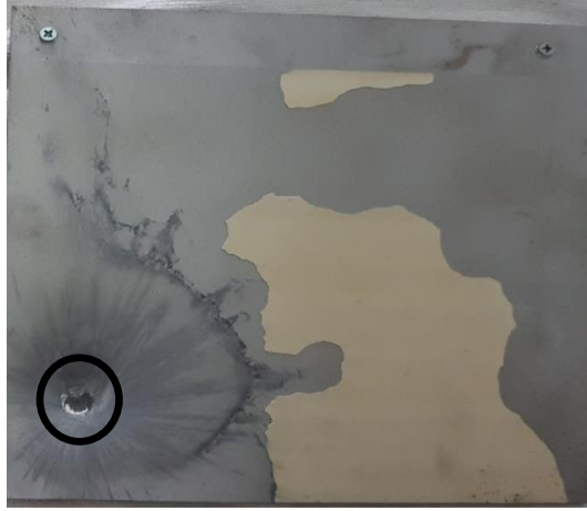
Şekil 6.11: Zirkonyum oksit kaplı plakanın balistik deney sonrasındaki görüntüsü.
