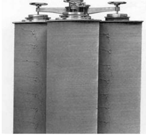
Şekil 1.13: Çözümlenmiş levendinde boyama aparatı (Çoban, 2005).
