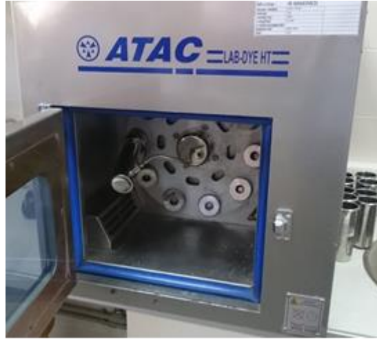
Şekil 4.9: IR ısıtma sistemli laboratuvar tipi boyama cihazı
