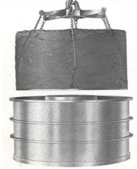
Şekil 1.9: Elyaf boyama aparatı(Çoban, 2005).
