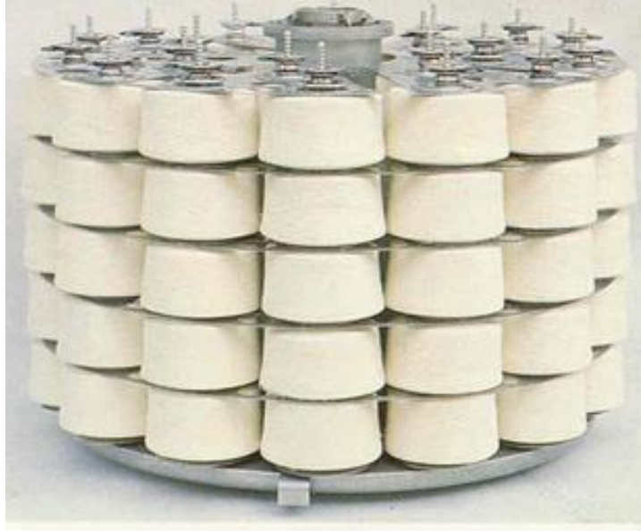
Şekil 1.12: Bobin boyama aparatı (Çoban, 2005).
