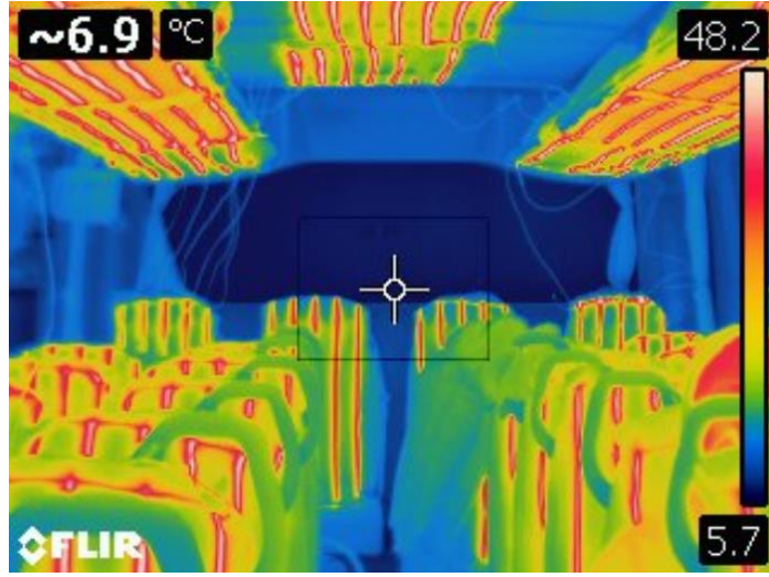
Şekil 4.27: -4 °C dış sıcaklıkta termal kamera koltuk görüntüsü.
