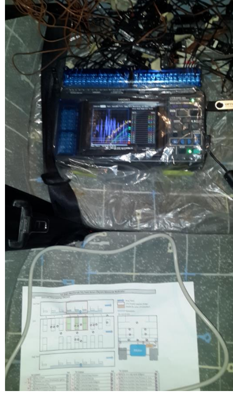
Şekil 4.35: Veri toplama cihazı araç içi yerleşimi ve ısı çift bağlantıları.
