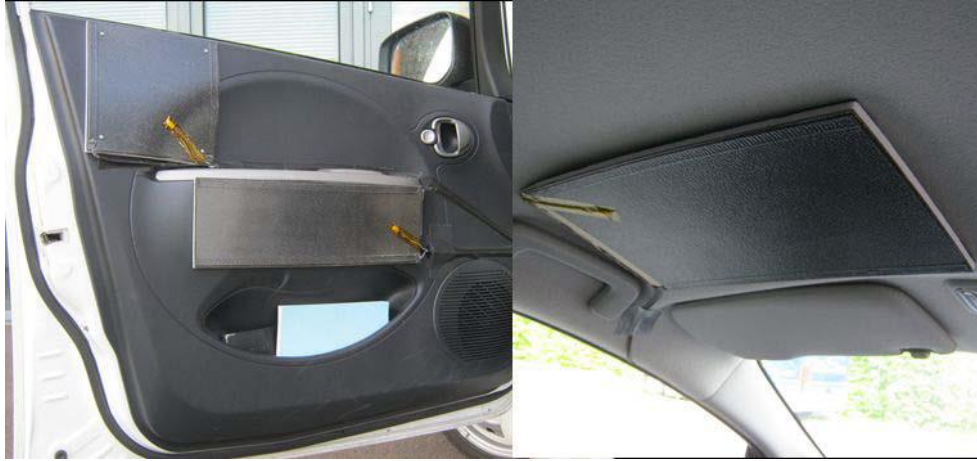
Şekil 1.1: Elektrikli binek araca yerleştirilmiş radiant (kızıl ötesi) ısıtıcı paneller (Baum vd., 2014).
