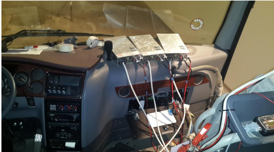
Şekil 3.31: Güç kaynaklarının yerleşimi.
