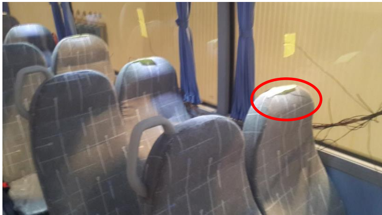
Şekil 4.32: Baş hizzası ısııl çift yerleşimi.
