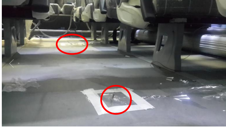
Şekil 4.30: Kabin zemini ısııl çift yerleşimi.
