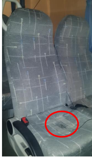
Şekil 4.31: Koltuk oturak bölgesi ısııl çift yerleşimi.
