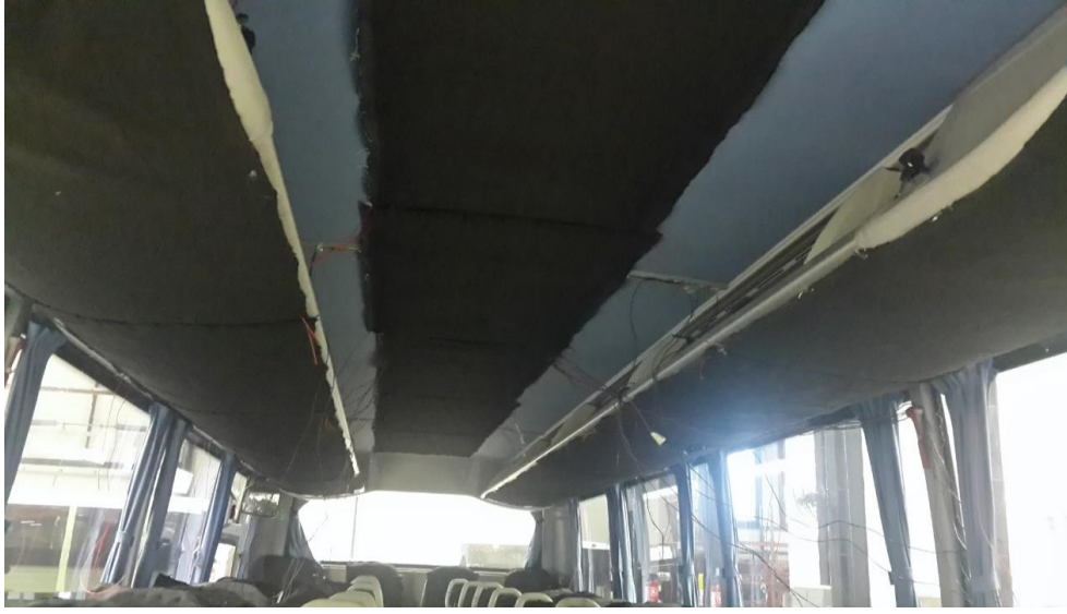
Şekil 3.26: Koltuk üstü tavan ısıtıcı kumaşı yerleşimi.
