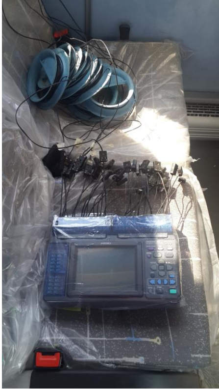
Şekil 4.35: Veri toplama cihazı araç içi yerleşimi ve ısı çift bağlantıları.
