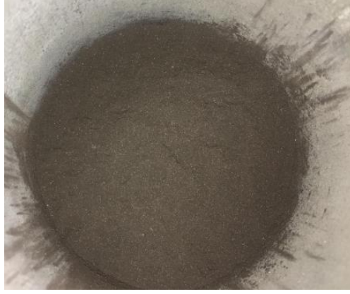
Şekil 5.4: Borlanacak numunelerin üzerinin kömür tozu ile kapatılması (3. Aşama).
