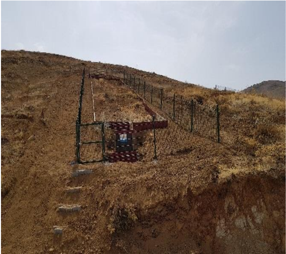
Şekil 2.11: Hamzabey mikrohavzasın TM sahası üzerine kurulan TM_T yüzeysel akış parselinden bir görünüm (Fotoğraf: Mahmut Yılmaz 2018).
