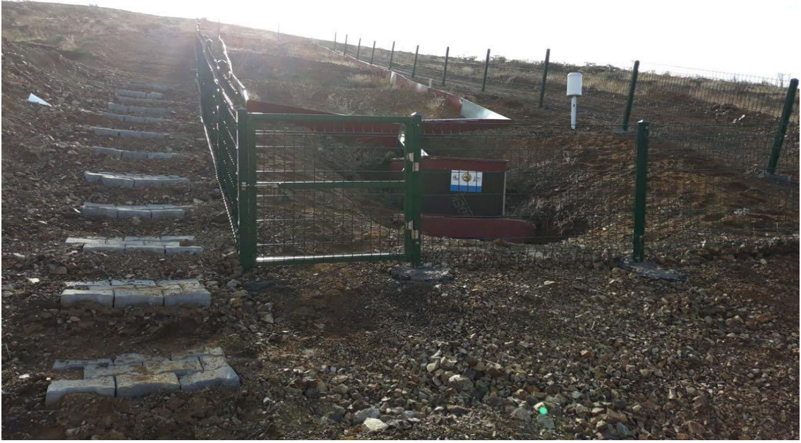
Şekil 2.12: Hamzabey mikrohavzasında TM sahası üzerine kurulan yüzeysel akış parseli ve yağış ölçer cihazından bir görünüm (Fotoğraf: Mahmut Yılmaz 2018).
