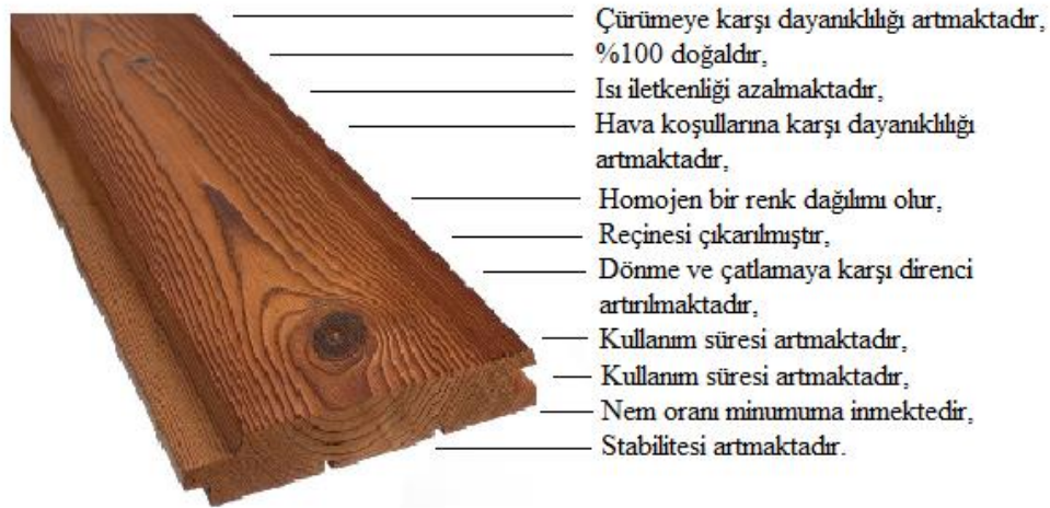
Şekil 1. 3: Isıl işlem uygulamasının ağaç malzemeye sağladığı olumlu özellikler (URL-1,2012).
