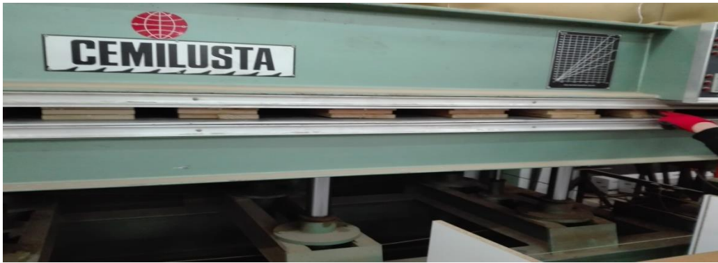
Şekil 3. 14: TAM yapışmada presleme işleme (Foto: M. GÜLCEMAL, 2018).
