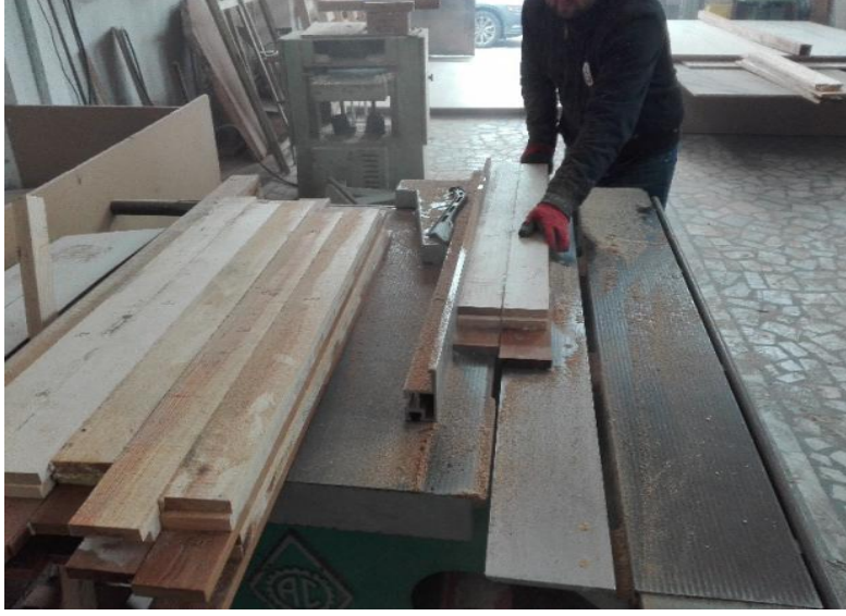
Şekil 3. 9: ÇLK malzemelerinin ebatlanması işlemi (Foto: M. GÜLCEMAL, 2018).
