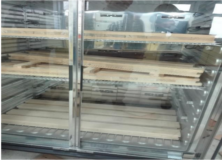
Şekil 3. 10: ÇLK malzemelerinin klimatize işlemi (Foto: M. GÜLCEMAL, 2018).
