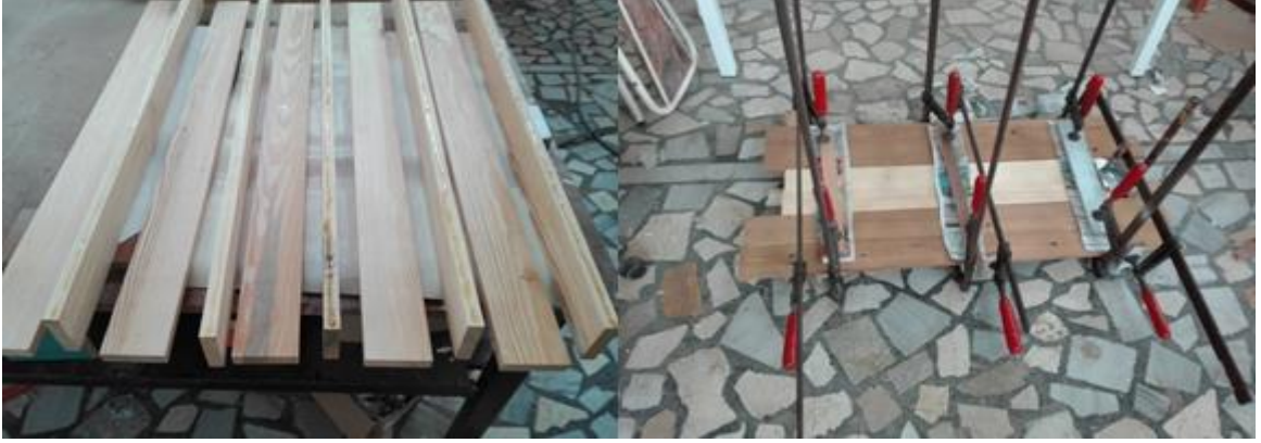
Şekil 3. 13: TAM örneklerinin tutkalanarak, işkence yardımı ile sıkıştırma işlemi (M. GÜLCEMAL, 2018).
