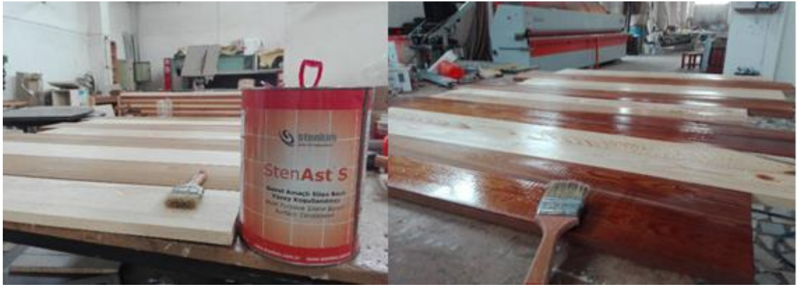
Şekil 3. 6: ÇLK örneklerine silan astar uygulanışı (Foto: M. GÜLCEMAL, 2018).
