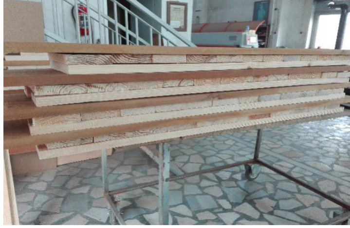
Şekil 3. 7: ÇLK örneklerinin presten önce hazırlanışı (Foto: M. GÜLCEMAL, 2018).
