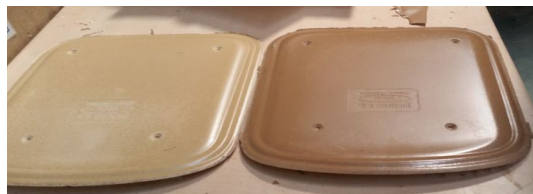
Şekil 1.6: Barrier Brown kağıdı pres sonrası olası üretim hatası.
