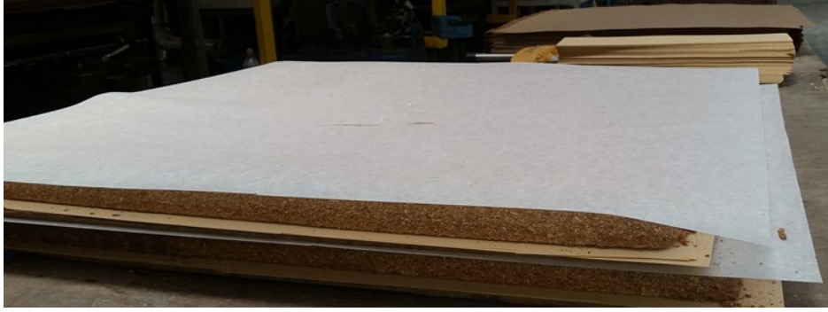
Şekil 1.7: Krep kâğıdın levha taslağına yüzeyine yerleştirmesi.
