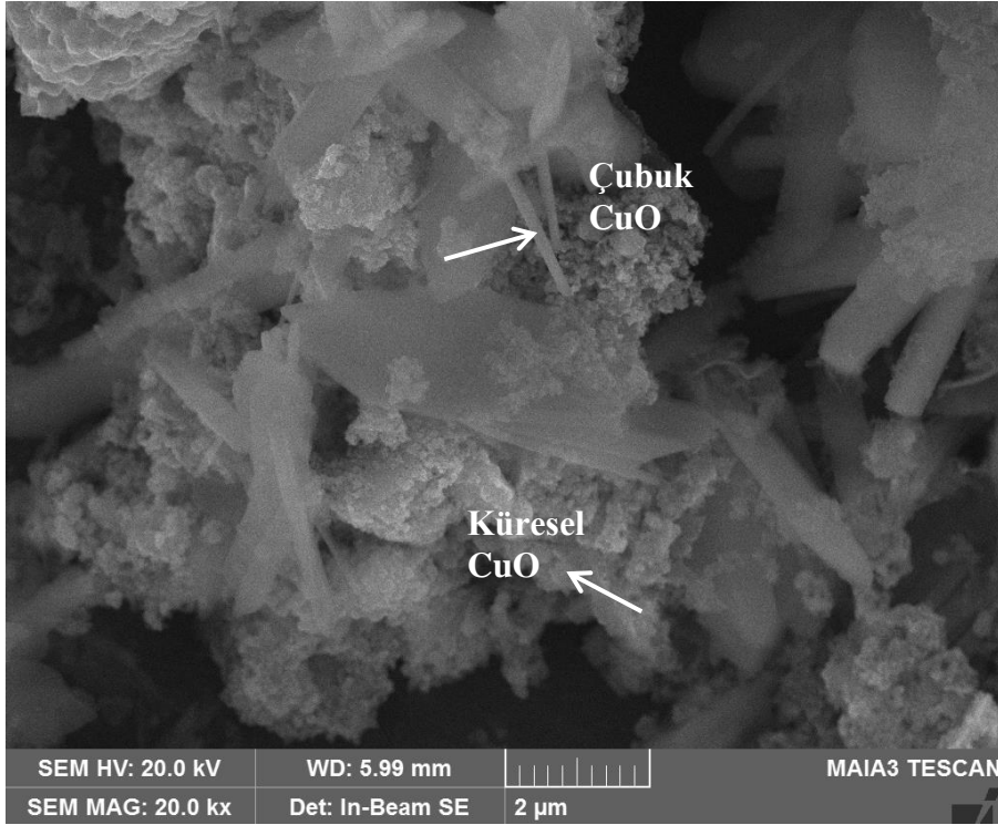
Şekil 4.4: Yanma yöntemiyle hazırlanan CuO nanopartiküllerinin SEM görüntüsü.
