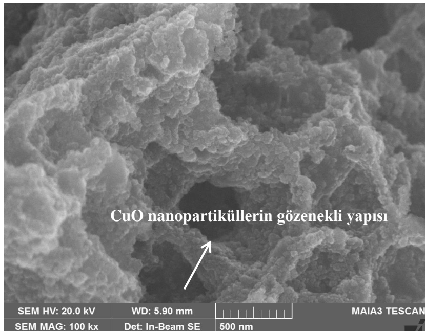
Şekil 4.3: Yanma sentezi yöntemi ile hazırlanmış metal oksit nanoparçacık gözenekli yapısının SEM görüntüsü.
