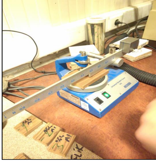
Şekil 2.9: Numunelere çizilme testi uygulaması.
