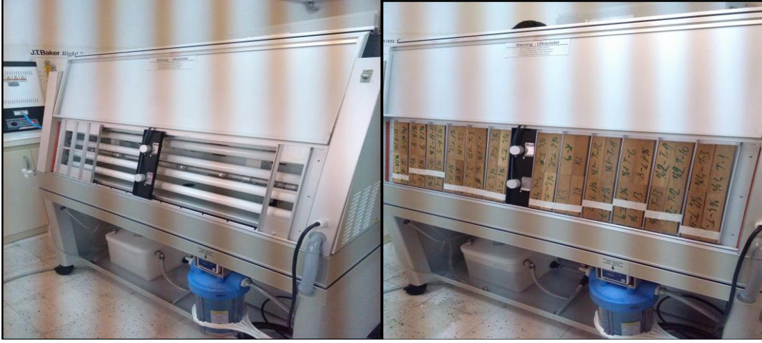
Şekil 2.5: Örneklerin hızlı yaşlandırma cihazına yerleştirilmesi.
