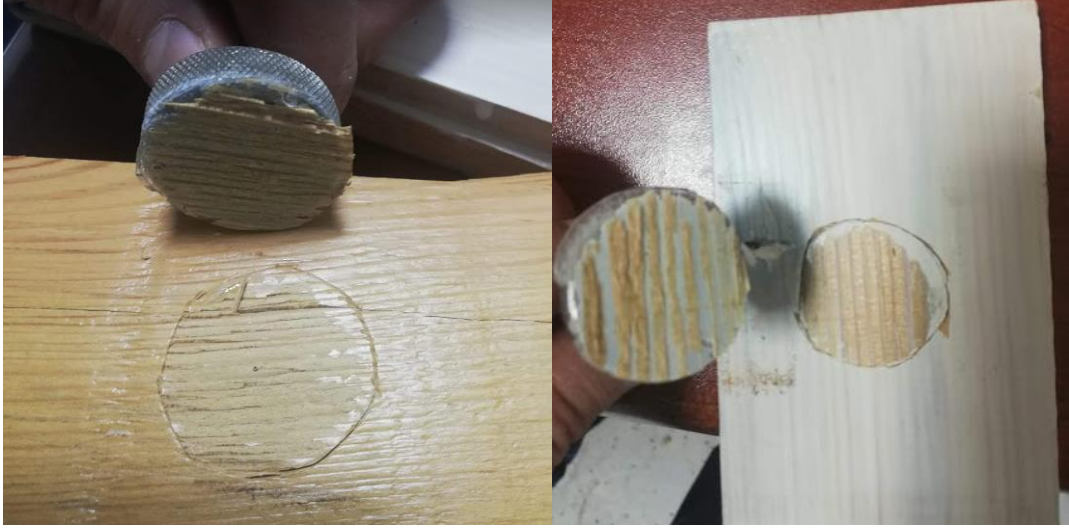
Şekil 3.8: Yüzey saęlamlığı testi kopma örnekleri.
