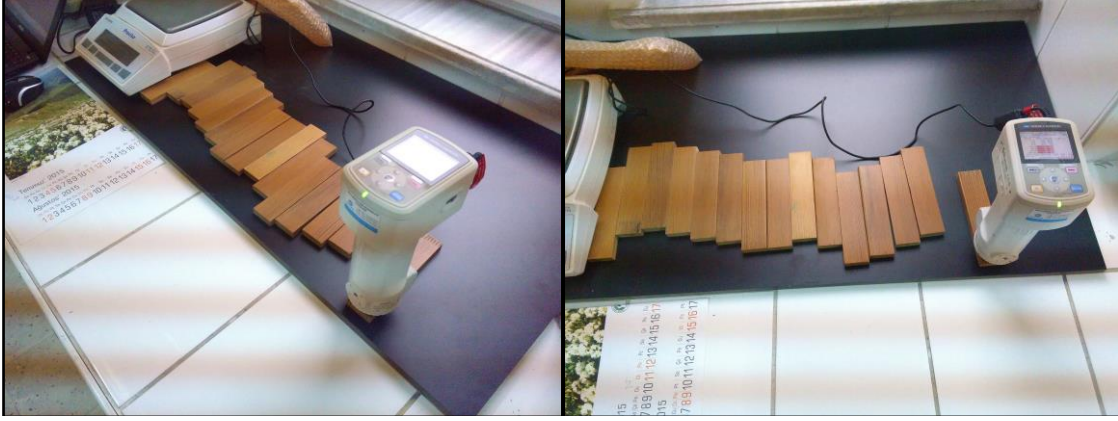
Şekil 2.7: Test örneklerine renk testi yapılması.
