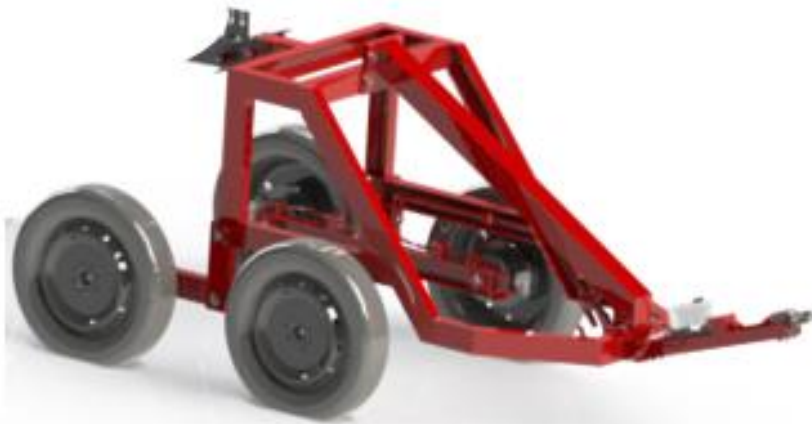
Şekil 3.6: Ürünün bir ucunun askıda taşınmasına imkân veren römork (tasarlanan 1. ekipman).
