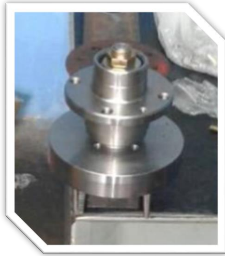
Şekil 6: Aks ve fren merkezi bloğunun ana taşıyıcı ile porya ve tandem taşıyıcıları
