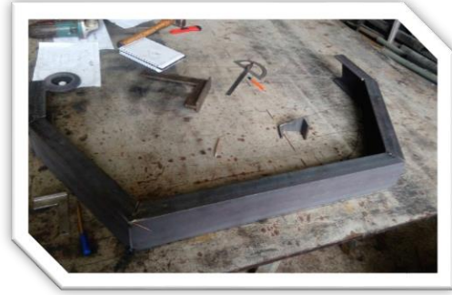
Şekil 2: Şasenin yukarı kaynaklı olan parçaları
