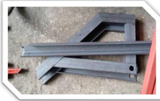
Şekil 2: Şasenin yukarı kaynaklı olan parçaları
