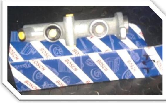
Şekil 4: Ana fren merkezi ve tandem fren sisteminin karşı yatak merkezlemesi
