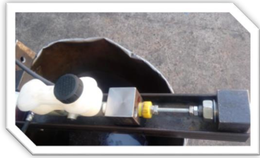
Şekil 12: Çekici demiri üzerinde yer alan ana fren merkezi
