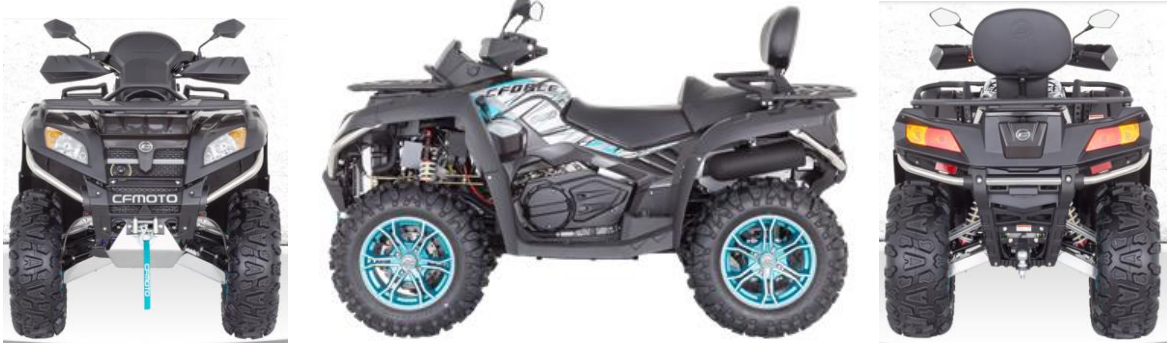
Şekil 3.3: Çalışma kapsamında kullanılacak ATV (800 cc silindir hacmine sahip 4×4 arazi aracı).
