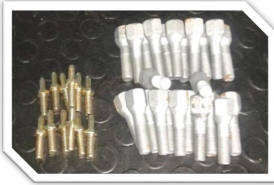
Şekil 5: Jant merkezi ve bijon cıvataları ile kamalar
