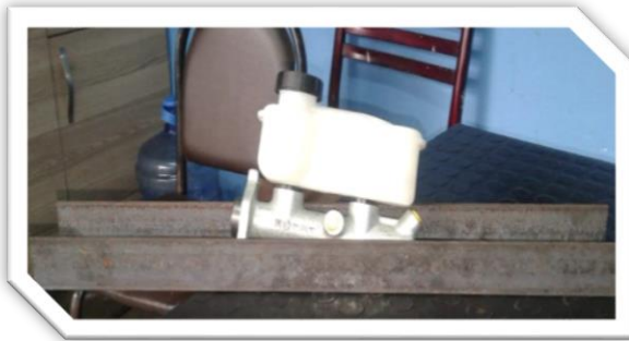
Şekil 12: Çekici demiri üzerinde yer alan ana fren merkezi
