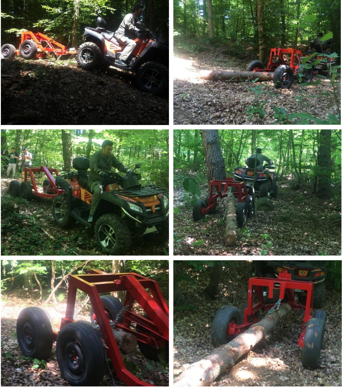
Şekil 4.6: Lastik tekerlekli ATV kullanılarak ürünün bir ucunun askıda taşınmasına imkân veren römork ile sürütme işlemi.
