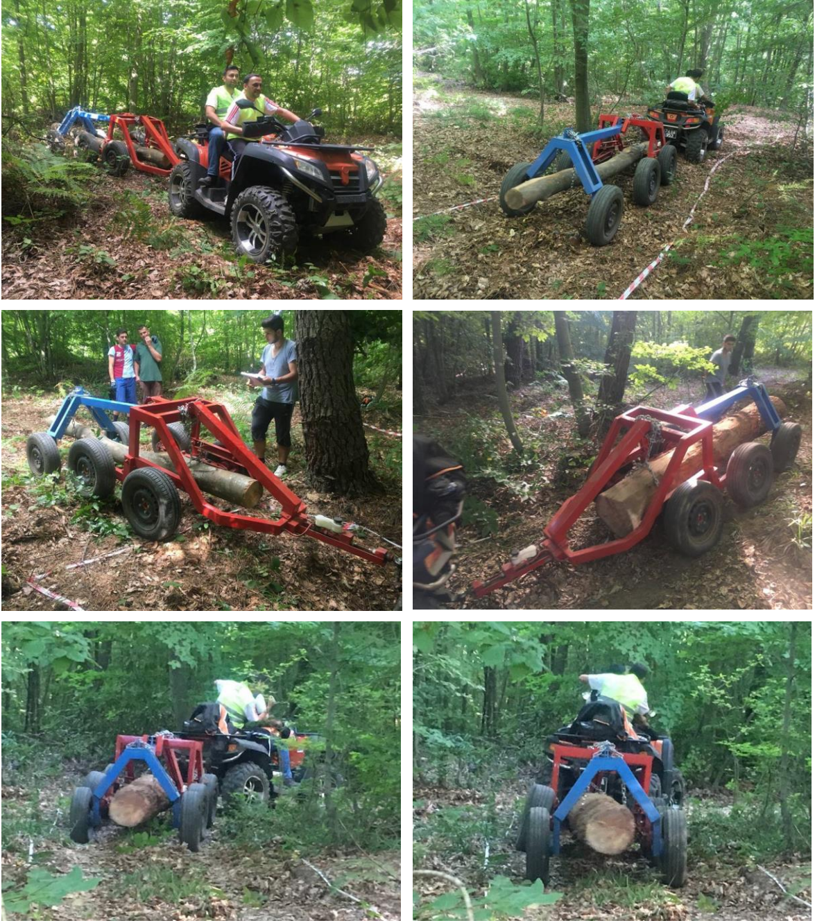
Şekil 4.7: Lastik tekerlekli ATV kullanılarak ürünün her iki ucunun askıda taşınmasına imkân veren römork ile sürütme işlemi.
