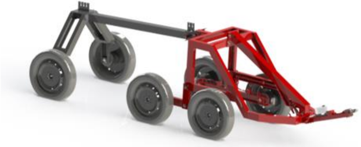
Şekil 3.7: Ürünün iki ucunun askıda taşınmasına imkân veren römork (tasarlanan 2. ekipman).
