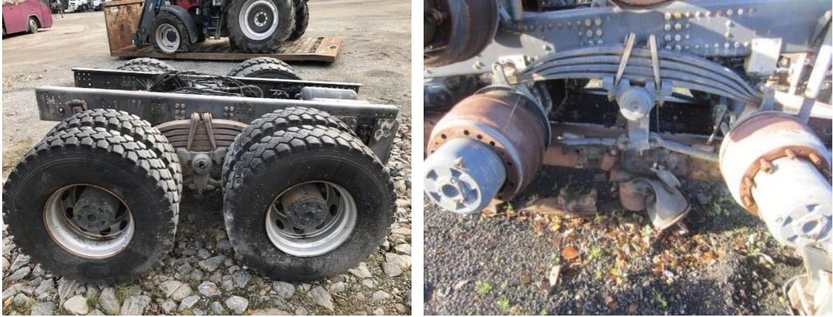
Şekil 3.29: Çok yük taşıyabilme beklentisi olan ağır araçlarda süspansiyon sistemi.
