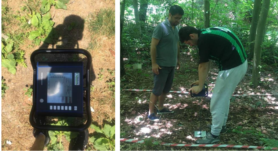
Şekil 4.2: İşlem görmemiş toprak sıkışıklığı değerlerinin penetrologger toprak sertlik ve sıkışıklık ölçer cihazı ile ölçümü.
