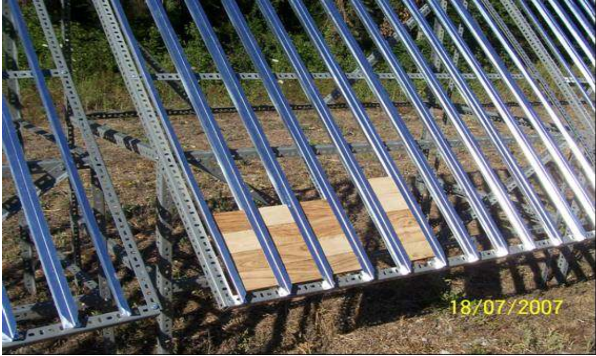
Şekil 2.3 Örneklerin panellere yerleştirilmesi.
