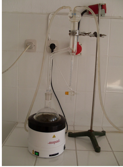
Şekil 2.4 Cleverger aparatı (Fotoğraf: Ezgi FIRINCIAHMETOĞLU 2009).
